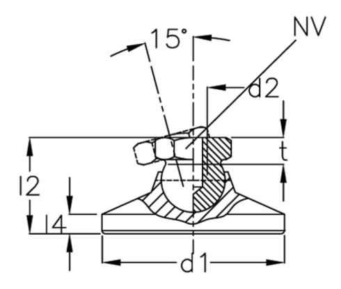
d1 = 32 d2 = 10 l2 = l4 = -NV = 15 Static load (kN) = 23 t min = 10.5
